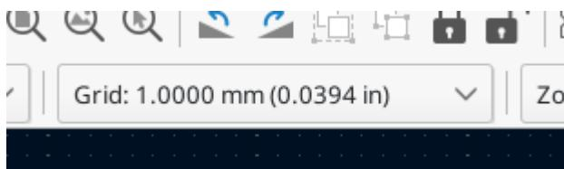
Per disegnare sul livello "Edge.Cuts", fare clic su **Edge.Cuts** nella scheda Strati del pannello Aspetto a destra. Scegliere lo strumento rettangolo nella barra degli strumenti a destra e usarlo per disegnare un rettangolo che circonda approssimativamente le tre impronte. Anche gli altri strumenti grafici (linea , arco , cerchio o poligono ) possono essere usati per disegnare il bordo della scheda; l'unico requisito è che sia un'unica forma chiusa che non si intersechi.
