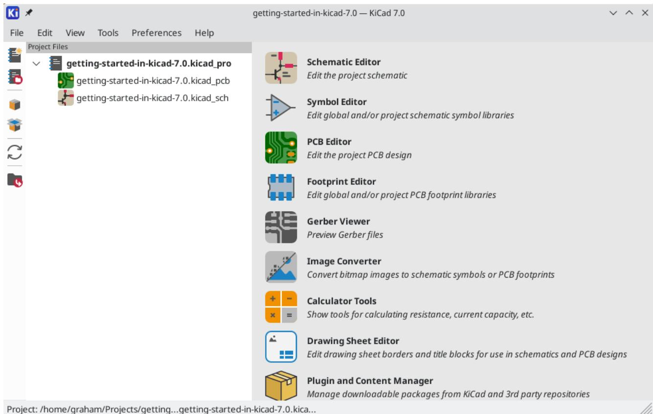
A sinistra, il riquadro **File progetto** elenca i file nel nuovo progetto. C'è un file progetto con estensione `.kicad_pro`, un file schema con estensione `.kicad_sch` e un file circuito stampato con estensione `.kicad_pcb`. Questi file condividono tutti lo stesso nome del progetto.
