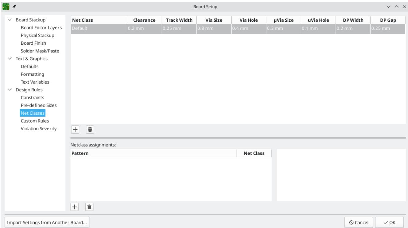
Track width and spacing can be managed manually by the designer during layout, but net classes are recommended because they provide an automatic way to manage and check design rules. Larghezze e spaziature piste possono essere gestite manualmente dal progettista durante la stesura del C.S., ma l'uso delle netclass è consigliato perché forniscono un modo automatico per gestire e controllare le regole di progettazione.
