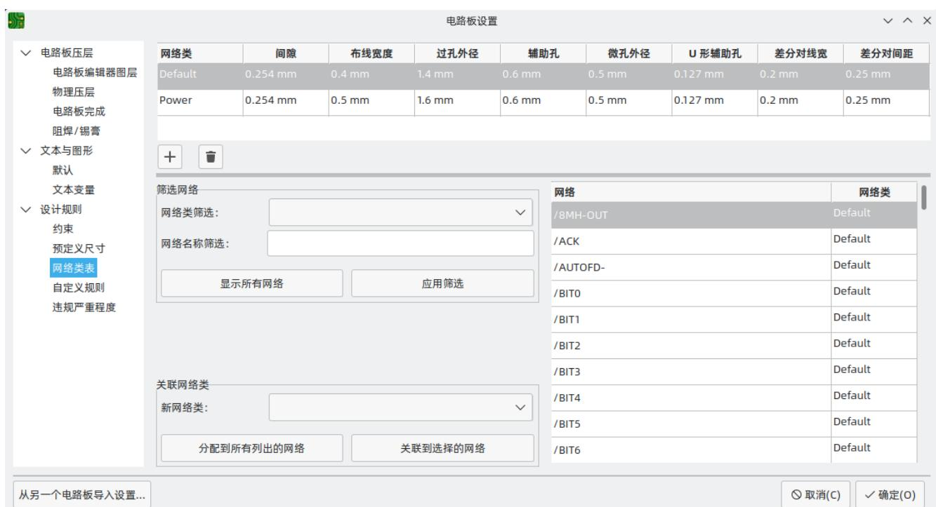
网络类部分的上部有一个表格，显示了设计中的网络类和适用于每个网络类的设计规则。每个类别都有铜的间隙、布线宽度、过孔尺寸和差分对尺寸的值。这些值将在创建布线和过孔时使用，除非有更具体的规则覆盖它们（见下面的自定义规则）。
